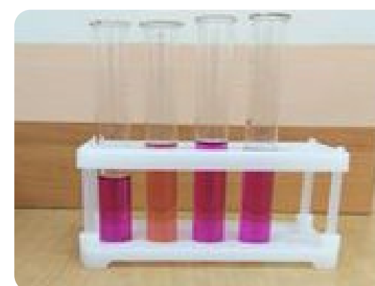
Рис 7, 8. Обнаружение органических веществ (окисляемости воды): слева направо а) начало опыта; б) через 40 мин.
