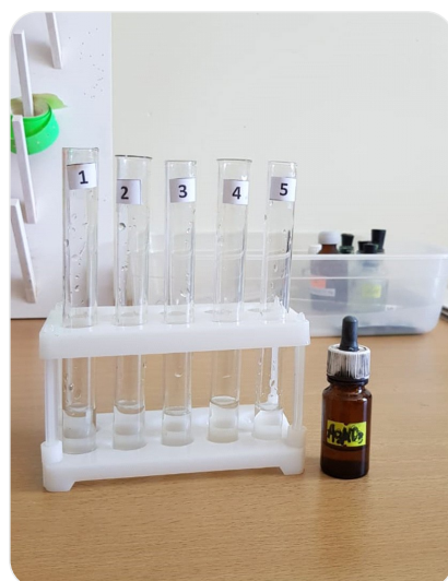
Рис. 11, 12, 13. Определение содержания анионов хлора.
