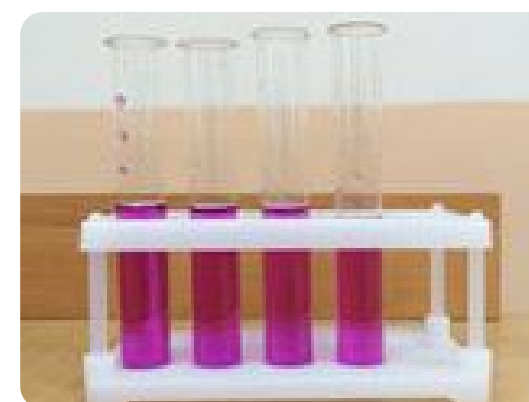
Рис. 5, 6. Обнаружение катионов тяжелых металлов.
